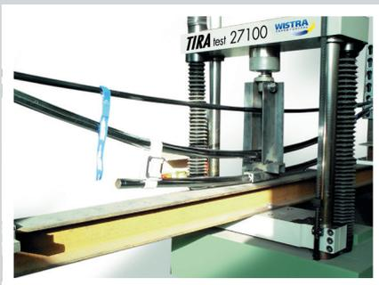
Auf eigenen Prüfeinrichtungen werden die Kleiderstangen in regelmäßigen Abständen Belastungsversuchen unterzogen.
