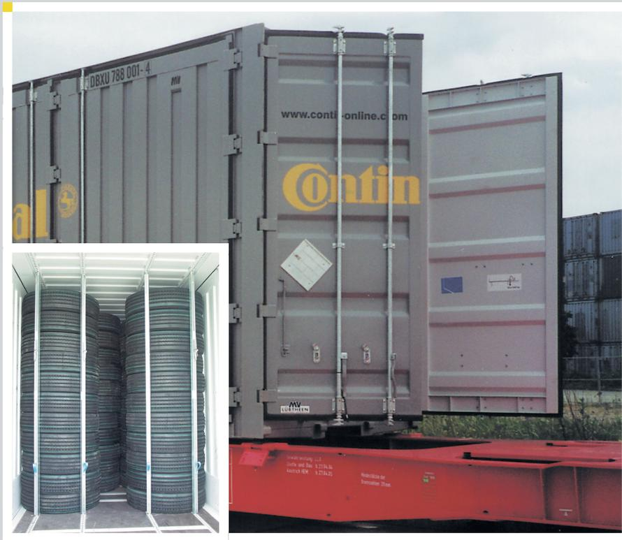
WISTRA Sperrbalkensystem Lock ist ein Formschluss-System mit Zapfearretierung in den Zurrschienen.
