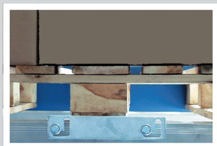
WISTRA Doppelstocksysteme werden für unterschiedliche Ausführungen von Führungsschienen gefertigt und können höhenvariabel fixiert werden.
