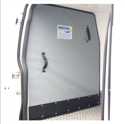
Durch den mehrschichtigen Aufbau sind die Trennwände leicht in der Handhabung und robust im Einsatz. Die Unterkante ist als stoßfeste Sockelkante ausgebildet.
